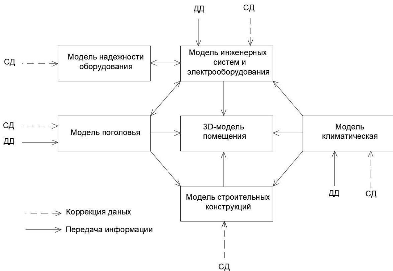
Рисунок 1 – Структура цифрового двойника помещения
