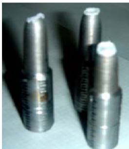
Рисунок 1 – Кратерообразная форма места разрыва образца из пластичного материала при растяжении
