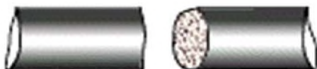
Рисунок 2 – Место разрыва образца из хрупкого материала по плоскости поперечного сечения при растяжении
