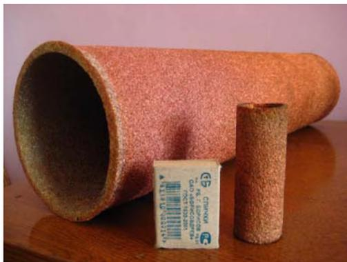
**Рисунок 1** - Фильтрующие элементы, изготовленные из медных волокон
