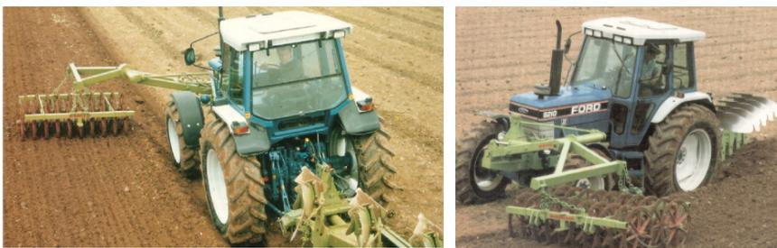
Рисунок 1 – Использование фронтального катка-почвоуплотнителя на пахотном агрегате
