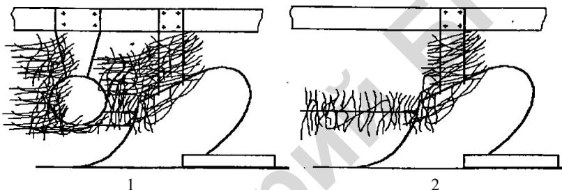
Рисунок 1 – Забивание корпуса плуга: 1 – с дисковым ножом; 2 – без дискового ножа
