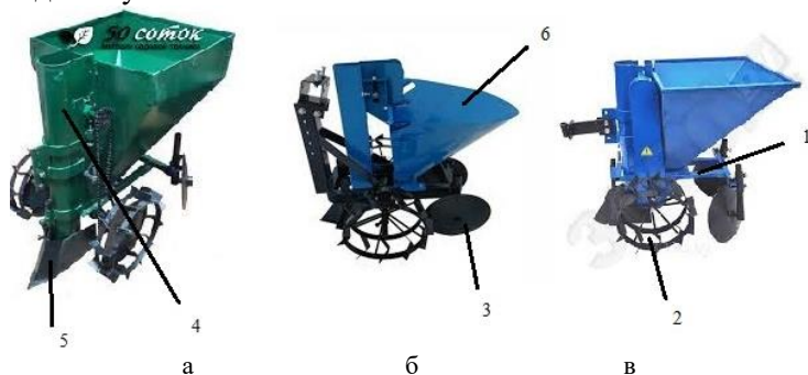
1 – рама; 2 – приводные колеса; 3 – заделывающие диски; 4 – высаживающий аппарат; 5 – килевидный сошник; 6 – бункер
