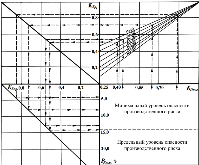
Рис. 3.6. Номограмма для определения уровня опасности производственного риска с учетом интенсивности выполнения технологических регулировок
