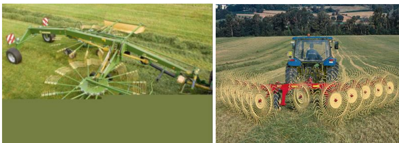
а – ротационные Swadro фирмы «KRONЕ» б – колесно-пальцевые QR 10 фирмы «Sitrex S.p.A.» Рисунок 1 – Грабли-валкователи
