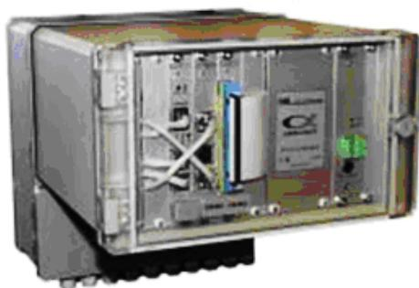
УСПД RTU-314 в корпусе без ЖКИ
