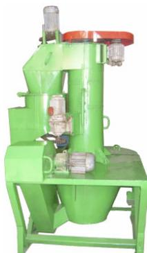
**Рисунок 1. Общий вид экспериментальной лабораторной установки для измельчения корнеклубнеплодов**
