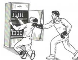
Рисунок 1.4 – Отделение пострадавшего от токоведущей части, находящейся под напряжением до 1000 В
