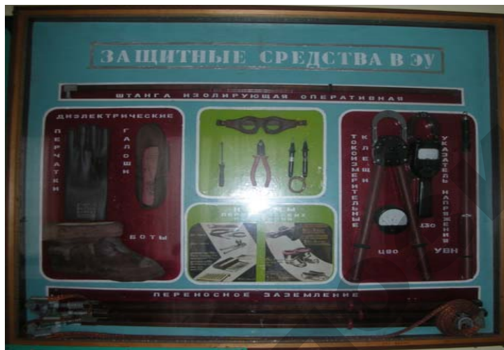
Рисунок 2.28 — Внешний вид стенда для изучения электротехнических защитных средств
