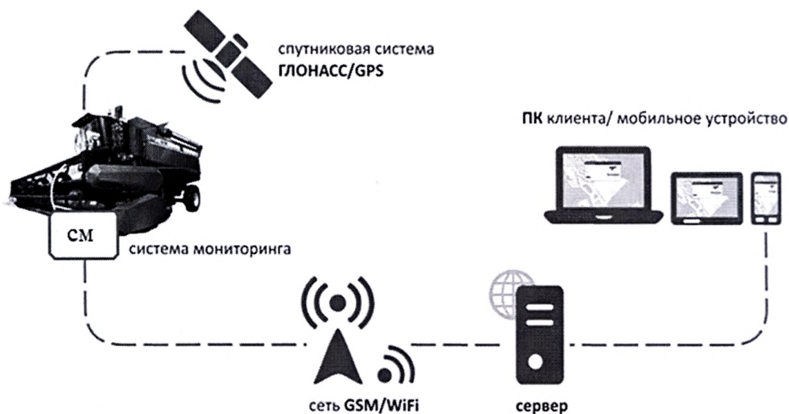
Рис. 1. Принцип работы ГНСС
