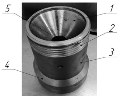
Рис. 2. Фотография предматричной камеры, внутренняя конфигурация которой выполнена в виде трубы Вентури: 1 — диффузор; 2 — резьба; 3 — корпус камеры; 4 — конфузор; 5 — горловина
