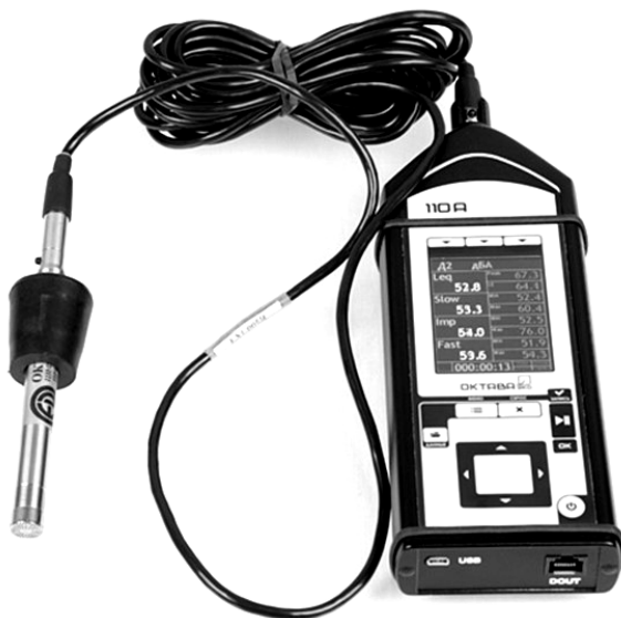
Рис. 1.8. Прибор для измерения шума и вибрации ОКТАВА-110А
