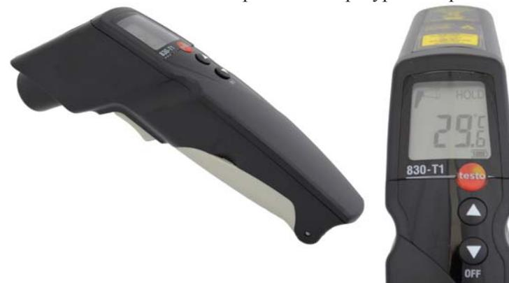
Рис. 1.8. Общий вид пирометра инфракрасного
