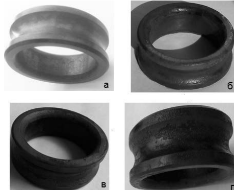
Рис. 3. Образцы внутреннего кольца подшипника, обработанного методом MAO и подвергнутого испытанию через определенное время: а – до начала эксперимента; б – через 120 часов; в – через 192 часа; г – через 288 часов
