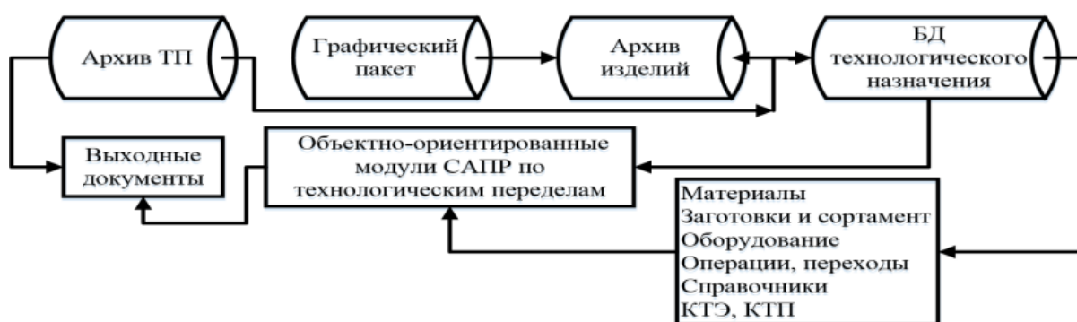
Рисунок 1. — Фрагмент структурной схемы интегрированной системы
