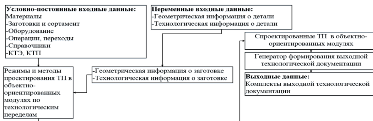
Рисунок 2. — Структура входных и выходных данных интегрированной системы
