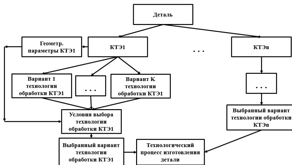
Рисунок 6. — Схема формирования технологического процесса изготовления детали методом структурного синтеза
