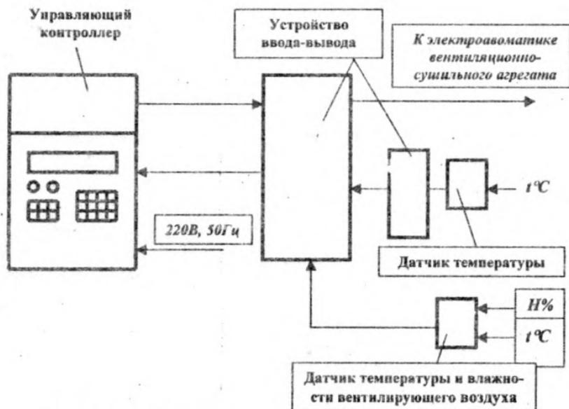
Рис.40. Схема автоматизированной системы управления
