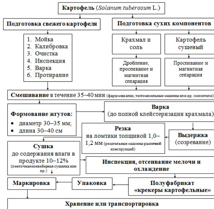
Рисунок 1. Технологическая (процессуальная) схема производства полуфабриката крекеров картофельных
