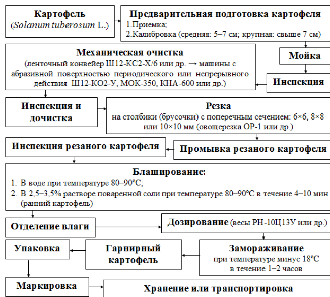
Рисунок 1. Технологическая (процессуальная) схема производства гарнирного картофеля быстрозамороженного
