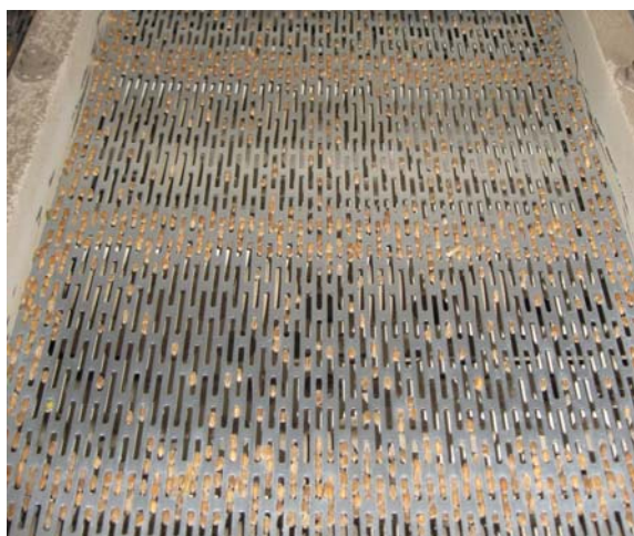
Рисунок 2 – Забиваемость решет в процессе эксплуатации («мертвые зоны»)
