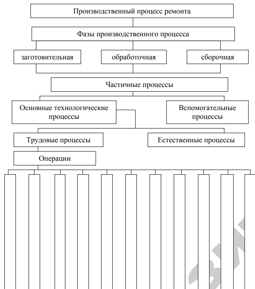
Рисунок. Структура производственного процесса на ремонтном предприятии
