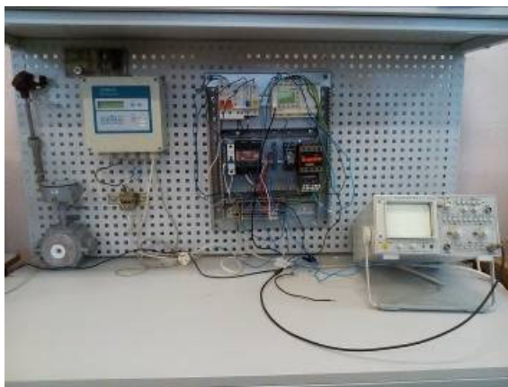
Рисунок 1 – Лабораторный стенд «Исследование электромагнитных расходомеров»
