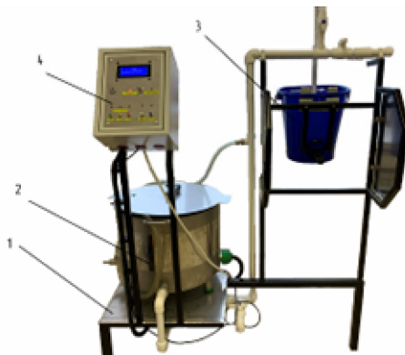
Рисунок 1 – Общий вид установки 1 – рама; 2 – емкость для подогрева жидких продуктов; 3 – ведро с соской; 4 – пульт управления
