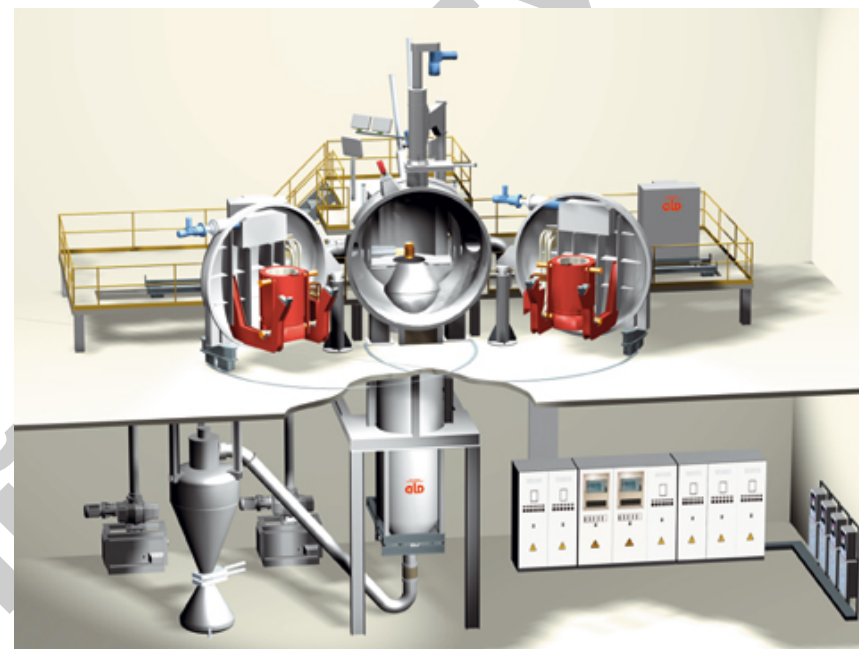
Рисунок 4.13. – Схема установки распыления для серийного производства с камерой плавления с двойными дверями
