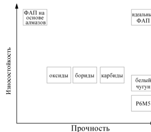
Рисунок 1.44. – Классификация ферроабразивных порошков по прочности и износостойкости
