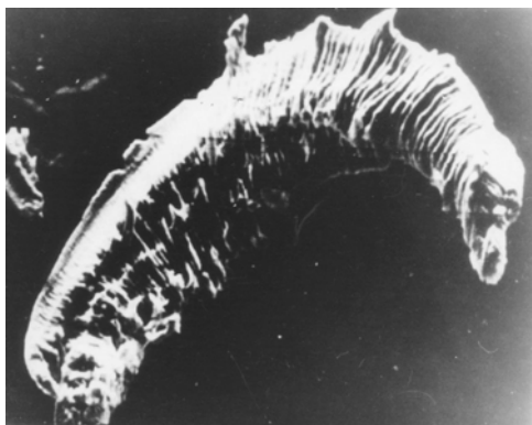
Рисунок 2.8. – Фотография стружки при МАО
