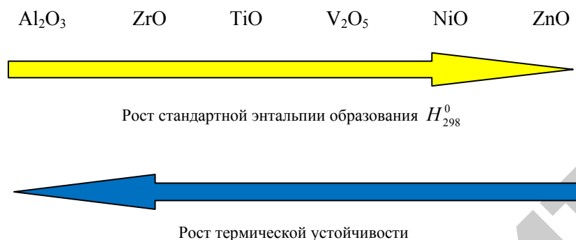
Рисунок 3.5. – Взаимосвязь стандартной энтальпии образования с термической устойчивостью оксидов металлов
