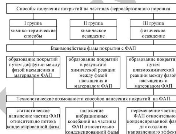
Рисунок 1.45. – Классификация способов нанесения покрытий на материал ФАП
