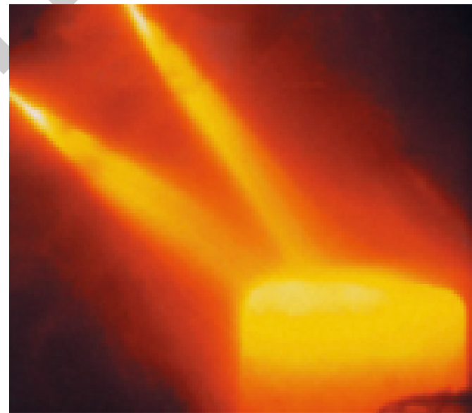
Рисунок 4.16. – Распылительная формовка с использованием двойного распылителя
