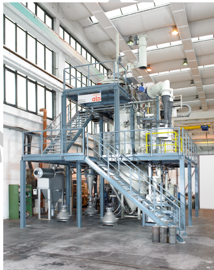
Рисунок 4.11. – Вакуумная установка для индукционной плавки и распыления инертным газом
