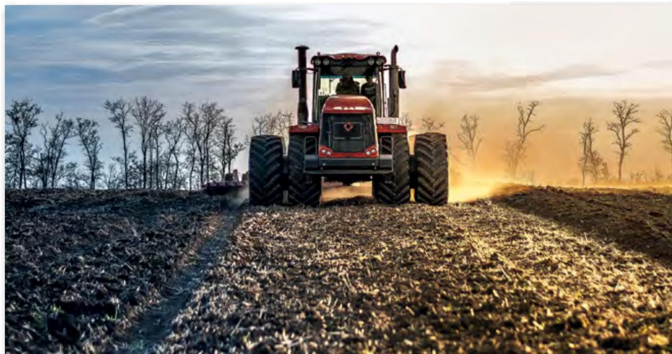
Обычно мобильные аграрные машины утрамбовывают почву на глубину, превышающую пахотный слой, в результате чего при многократном воздействии уплотнение накапливается не только в этом горизонте, но и в подпахотном пласте. В результате происходит сдавливание внутри грунта пор, через которые проникаются воздух и вода, что приводит к негативным для сельхозпроизводителя последствиям.
