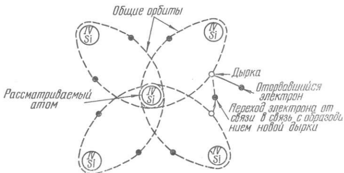
Рис. 1. Схема парноэлектронных связей в кристалле полупроводника и образование собственной проводимости кремния
