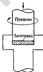
Рисунок 7.17. Схема ИПД методом кручения под высоким давлением
