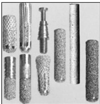
Рисунок 2.28. Зубные имплантаты из титанового порошка
