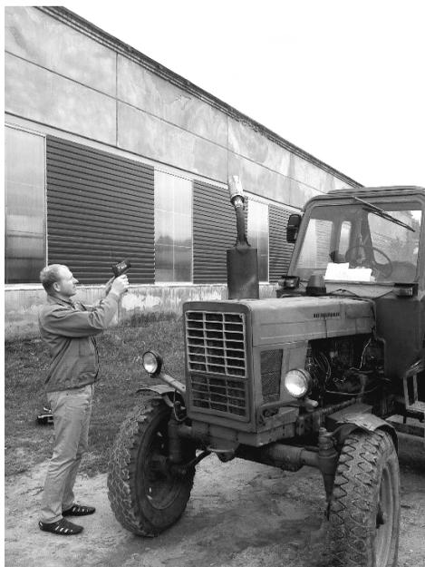
Рис. 4.22. Измерение температуры корпуса искрогасителя
