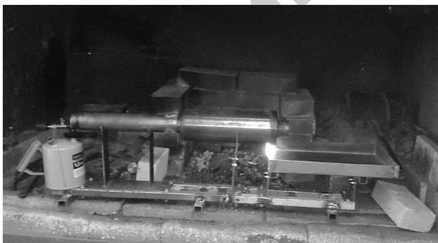
Рис. 4.9. Общий вид установки для определения огнепреграждающей способности сетчатого материала
