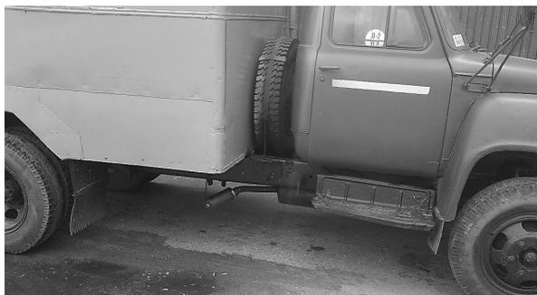
Рис. 4.20. Искрогаситель (выхлопная система ГАЗ-52)
