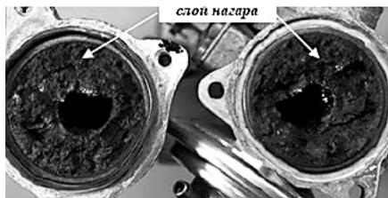
Рис. 1.1. Нагар в системе рециркуляции выхлопных газов (VW Passat) [2]
