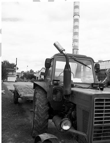
Рис. 4.19. Искрогаситель (выхлопная система МТЗ-80)
