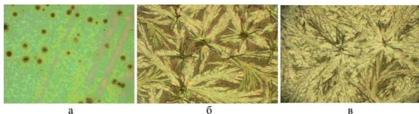
Рисунок 1 – Оптическое изображение поверхности пленки оксида ванадия после отжига при T = 400\text{ }^{\circ}\text{C} и различного времени отжига: а – 10 мин, б – 20 мин, в – 120 мин ( \times 1000 крат)
