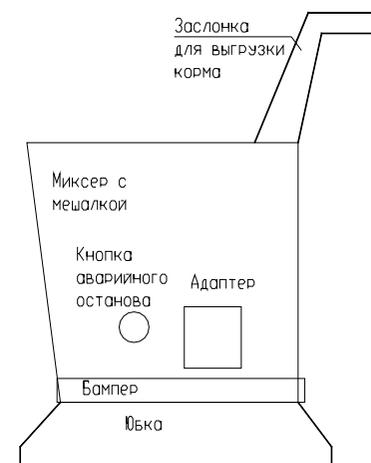
Рисунок А.25 – Устройство робота – подгребателя кормов
