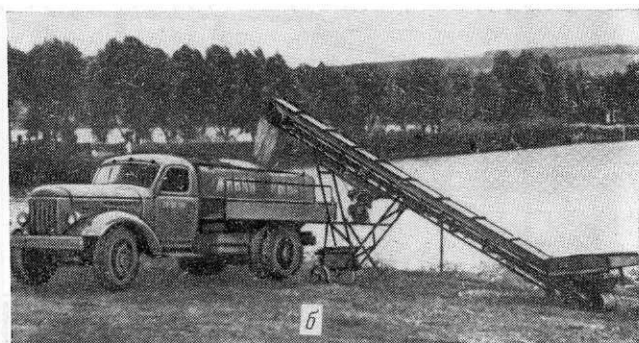
Рис. 132. Автоцистерна для перевозок живой рыбы АЦЖР-3:
