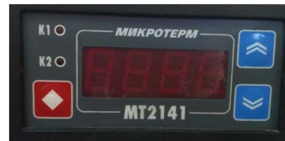
Рис. 60. Внешняя панель измерителя-регулятора температуры МТ2141
