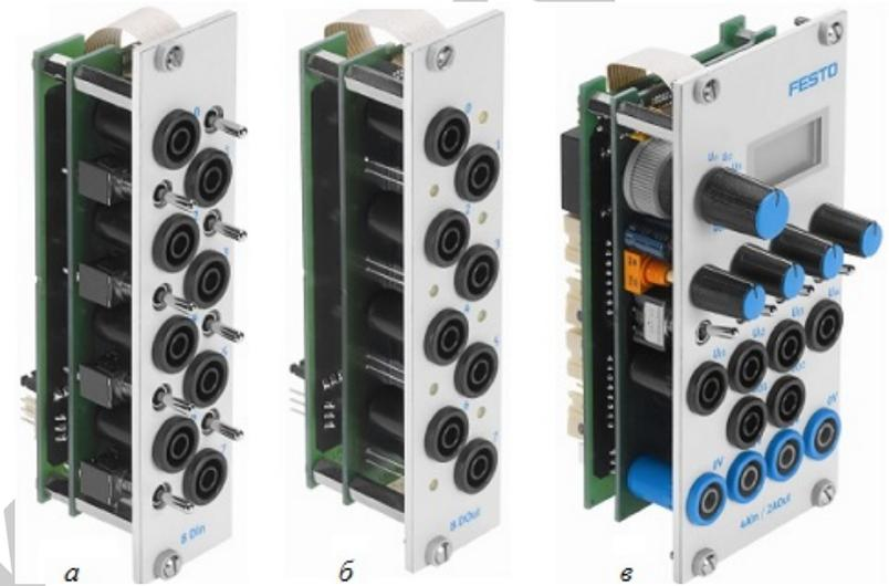
Рис. 52. Модули ввода/вывода цифровых и аналоговых сигналов
