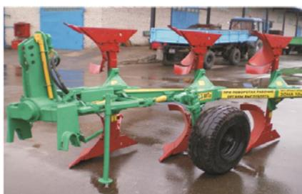
Плуг навесной оборотный ПНО-3-40/50 предназначен для гладкой вспашки старопашотных не засоренных камнями почв с удельным сопротивлением до 0,09 МПа. Плуг агрегируется с тракторами класса 2,0 («Беларус 1221»).
