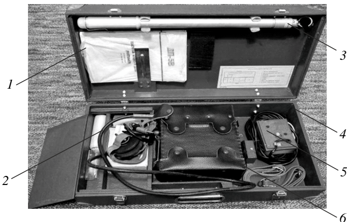
Рис. 1.2. Состав комплекта измерителя мощности дозы ДП-5В:
