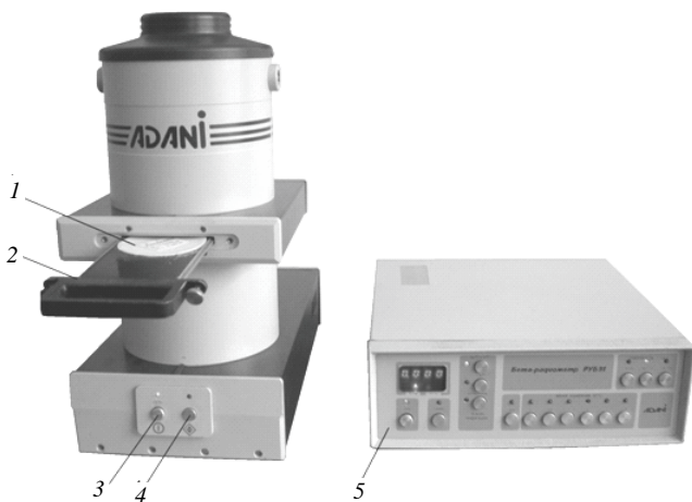
Рис. 8.1. Общий вид \beta -радиометра РУБ-91 «АДАНИ»:
