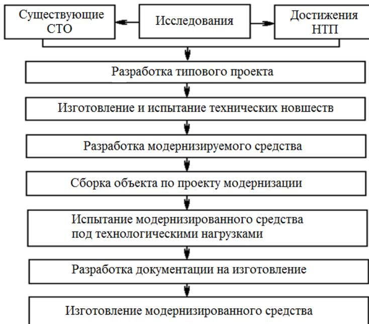
Рис. 4.4. Принципиальная блок-схема модернизации СТО
