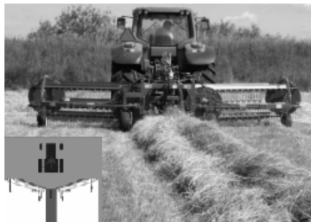
Рисунок 2 – Гребенчатые грабли-валкователи 7500FP («Reposi Macchine Agricole S.R.L.», Италия): а – фронтальное расположение; б – заднее расположение
