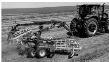
Рисунок 1 – Гребенчатые грабли-валкователи Rolabar rakes 230 («New Holland North America», США): а – общий вид; б – резинометаллические зубья, смонтированные на гребенчатых балках
