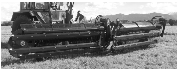
Рисунок 3 – Грабли-валкователи гребенчатого типа Clementer 550 F («Umwelttechnik», Германия)
