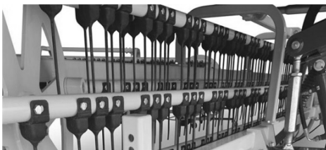
Рисунок 1 – Гребенчатые грабли-валкователи Rolabar rakes 230 («New Holland North America», США): а – общий вид; б – резинометаллические зубья, смонтированные на гребенчатых балках
