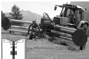
Рисунок 2 – Гребенчатые грабли-валкователи 7500FP («Reposi Macchine Agricole S.R.L.», Италия): а – фронтальное расположение; б – заднее расположение
