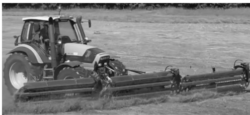
Рисунок 4 – Трехсекционная (модульная) система рабочих органов граблей-валкователей Clementer 550 F
