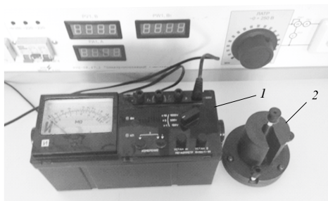
Рис. 2.3. Лабораторная установка: 1 – измерительная электродная система; 2 – мегаомметр
