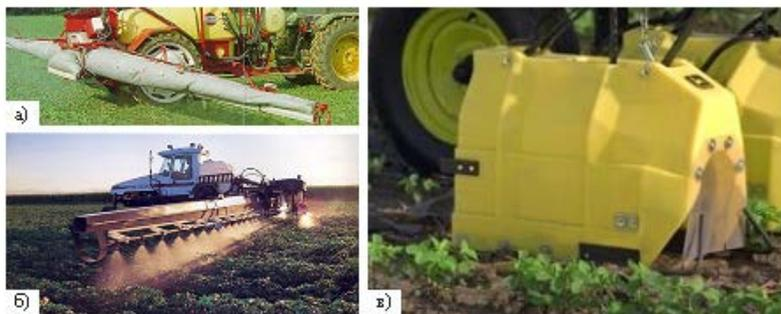
Рис. 2. Системы, снижающие снос рабочих растворов при опрыскивании:
