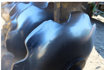
Рисунок 4 – Поверхность трения дискового рабочего органа, который эксплуатируется на песчаных и супесчаных почвах
