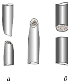
Рис. 2.1.4. Место разрушения образца: а – в виде кратера; б – по плоскости поперечного сечения
