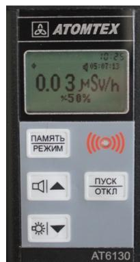
Прибор может находиться в одном из двух состояний: **режим индикации измерений** и **режим меню**. Для входа в режим меню необходимо нажать и слегка удерживать кнопку ПАМ/РЕЖ. Для возврата в режим индикации измерений эта же кнопка нажимается кратковременно.
