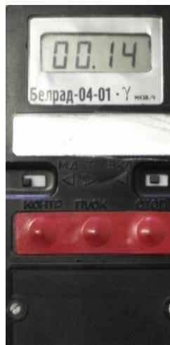
Задняя крышка прибора снимается при измерении плотности потока бета-частиц.
