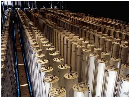
Рис. 8. Каскад центрифуг для обогащения урана
