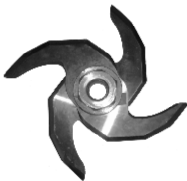
Рис. 17. Ножевая головка куттера с ножами новой конструкции и углом резания в середине прямолинейного участка режущей кромки 64^{\circ}11'
