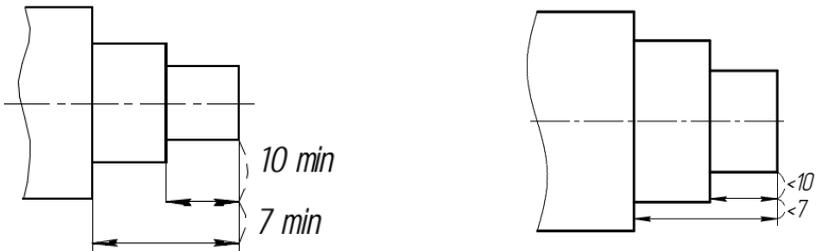
Рисунок 4 – правильное (слева) и неправильное (справа) нанесение размерных линий
