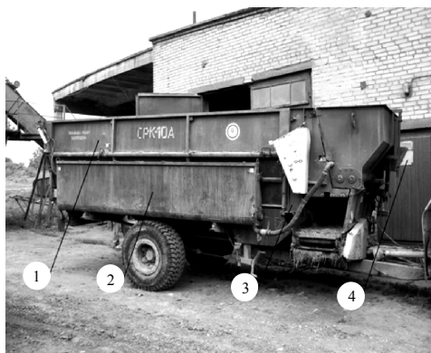
Рис. 3.14. Смеситель-раздатчик кормов СРК-10А: 1 – бункер для стебельчатых кормов; 2 – бункер для пастообразных кормов со шнековым насосом-дозатором; 3 – дозирующее устройство; 4 – устройство контроля загрузки кормов
