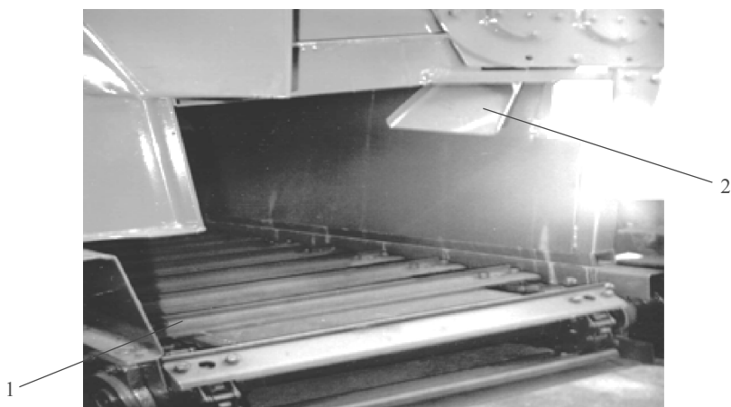
Рис. 2.17. Выгрузное окно подачи многокомпонентной высокоэнергетической добавки в поток стебельчатых кормов: 1 – выгрузной транспортер; 2 – лоток для выгрузки многокомпонентной высокоэнергетической добавки на кормосмесь
