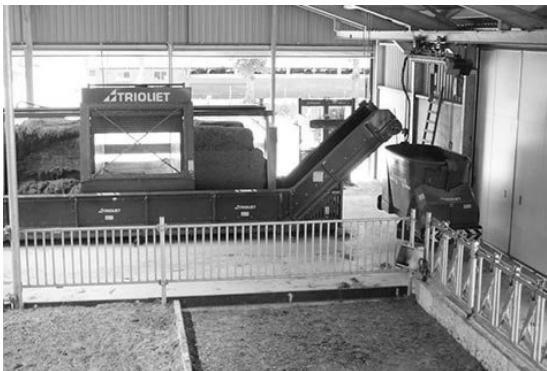
Рис. 1.13. Дозирование кормов для автоматических систем кормления Triomatic
