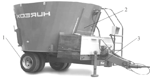
Рис. 1.5. Раздатчик кормов СРК-11 В: 1 – шасси; 2 – бункер; 3 – рама
