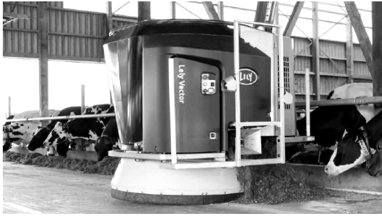
Рис. 1.12. Дозированная раздача кормов автоматической системы кормления Lely
