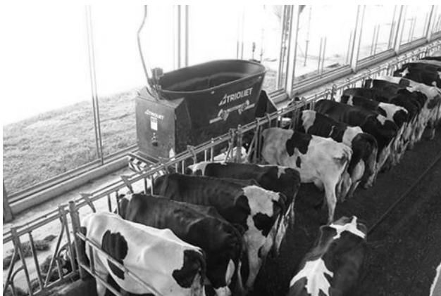
Рис. 1.14. Дозированная раздача кормов автоматической системы кормления Triomatic
