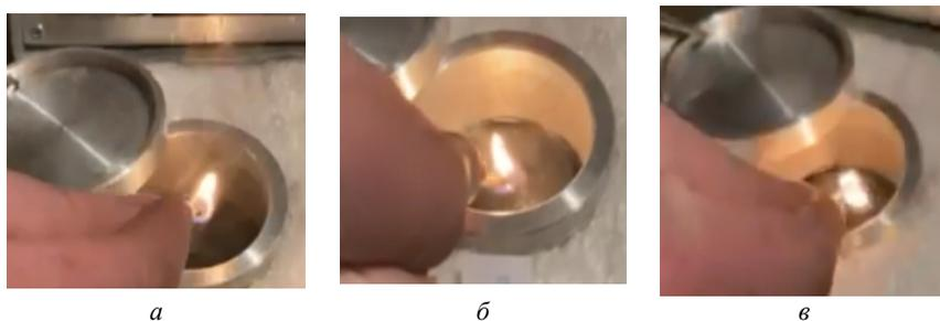
Рисунок 4 – Оценка наличия топлива в моторном масле
