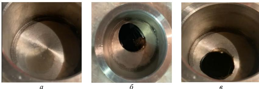
Рисунок 2 – Результаты экспресс-теста на содержание воды: *а* – свежего масла; *б* – работающего масла; *в* – отработанного масла
