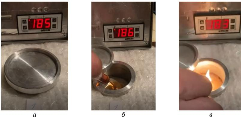
Рисунок 3 – Последовательность операций при оценке наличия топлива в моторном масле
