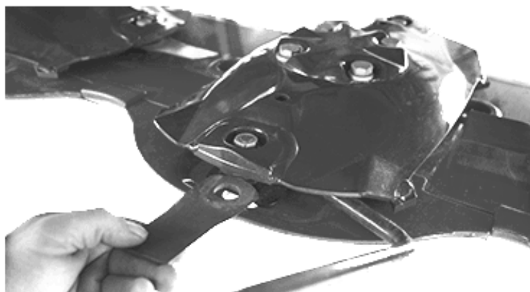
Рисунок 2.14 – Система быстрой замены ножей FAST-FIT
