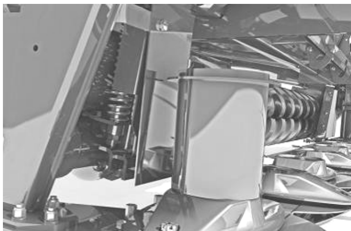
Рисунок 2.10 – Режущий аппарат дискового типа ротационной косилки Berkut 3200
