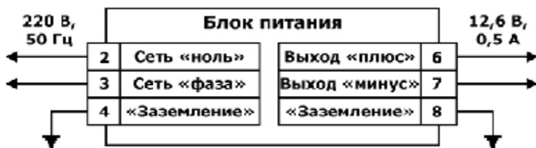
Рис. 40. Схема подключения защитного заземления блока питания
