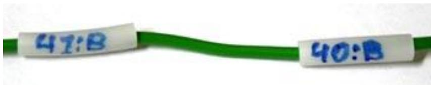
Рис. 3. Маркировка проводов
