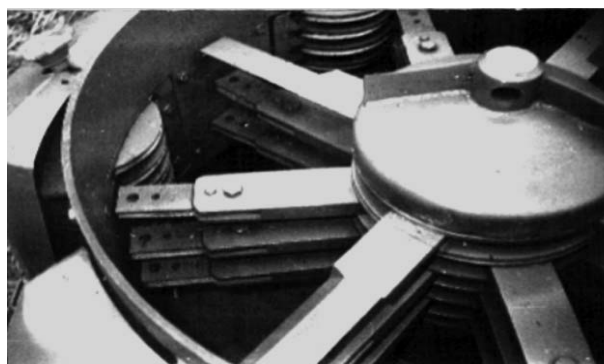
Рисунок 4. Измельчитель с установленными в державке двумя режущими ножами
